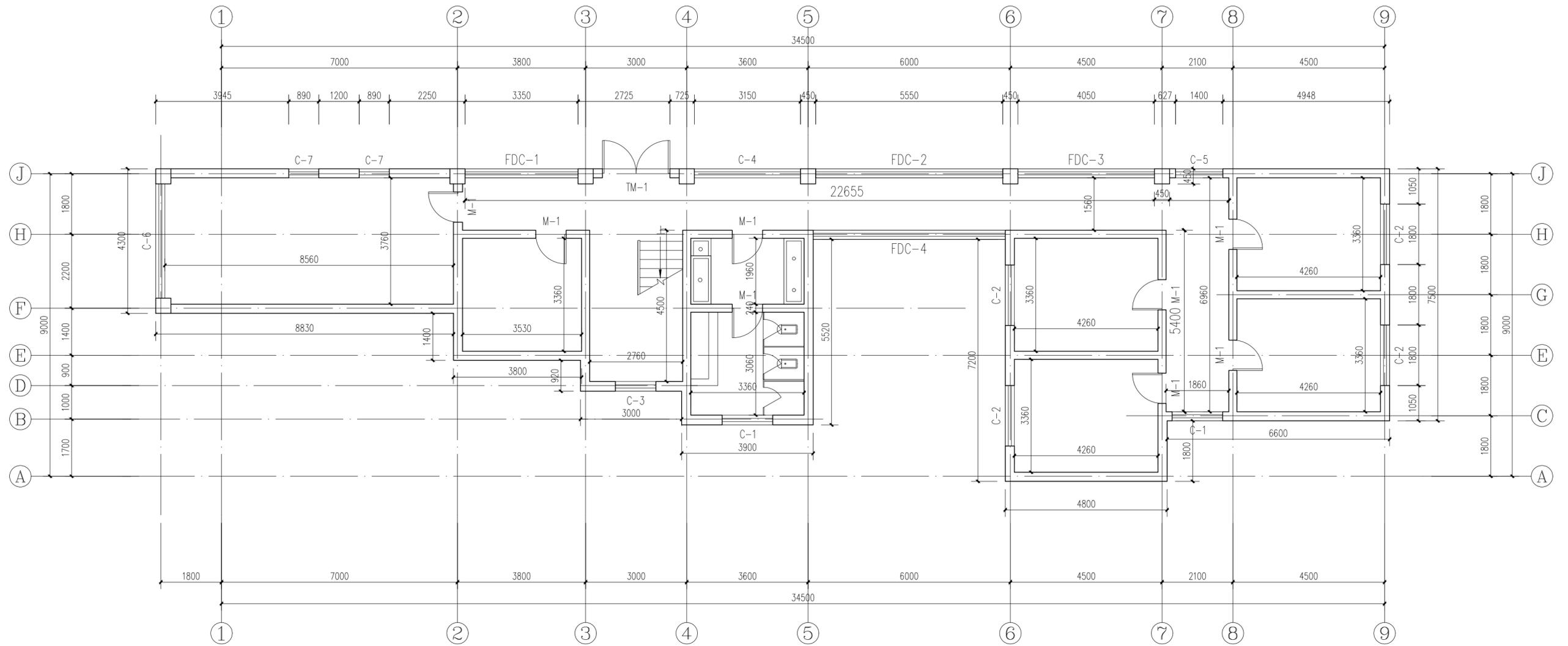
**一层平面图** [室内净高：3.43m]
